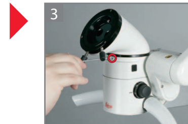
3 Затяните зажимной винт.
