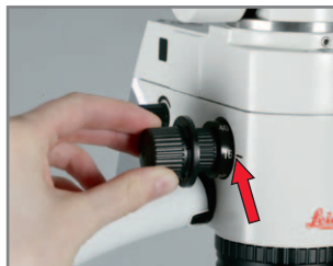
Регулятор увеличения с двух сторон, ступени: 6,4, 10, 16, 25, 40x
