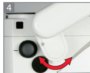
Установите желаемое положение. Можно установить четыре положения.
